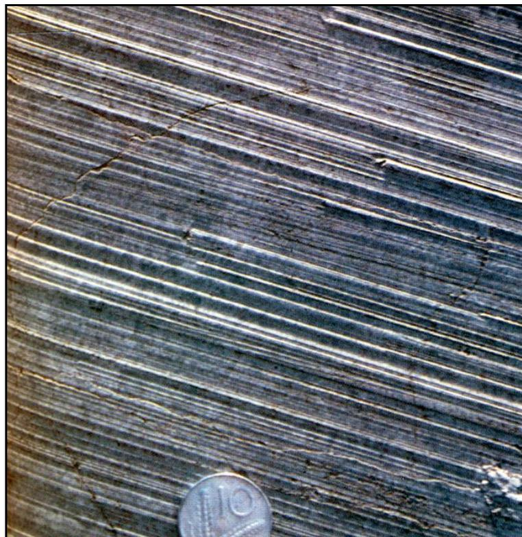
**Fig. 12 – Stries à faible pendage de miroir de faille**
